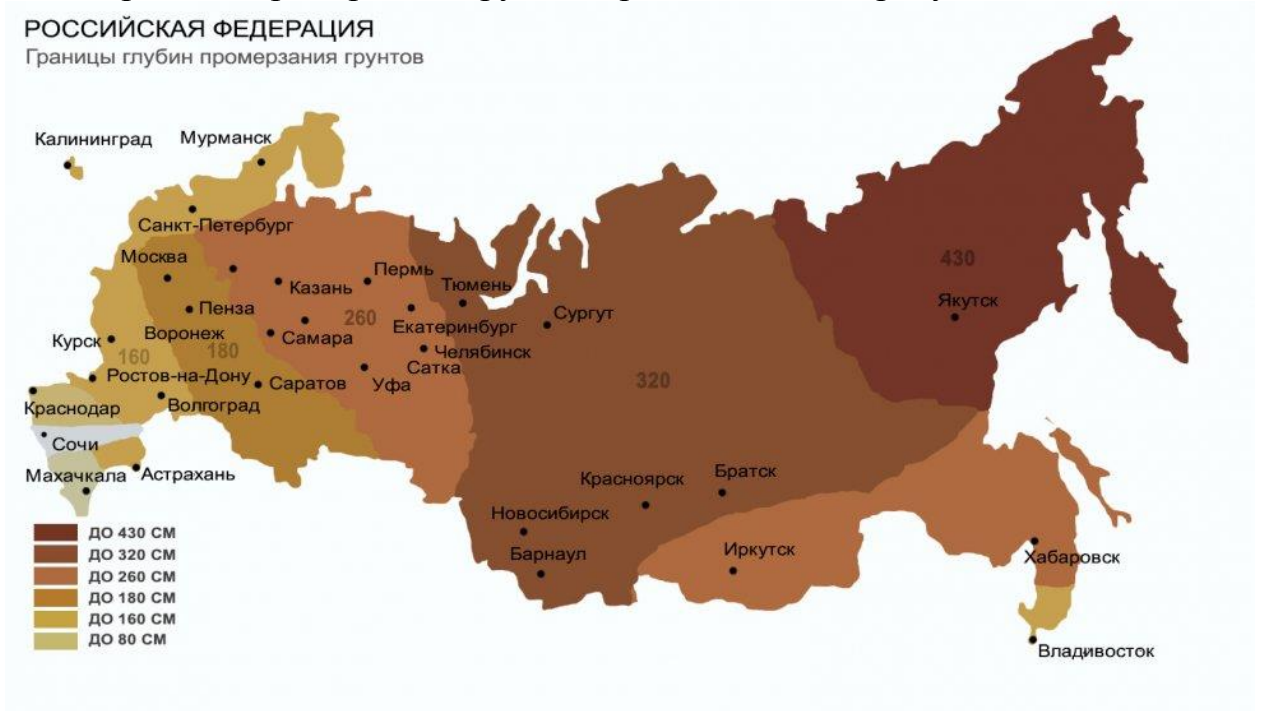
Рисунок 3 – Границы глубин промерзания грунтов
